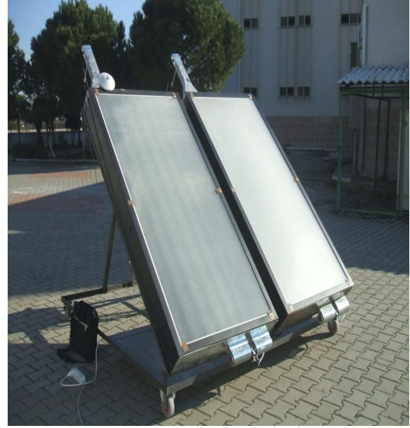
Şekil 1. Güneş enerjili hava kolektörlü deney seti resmi
